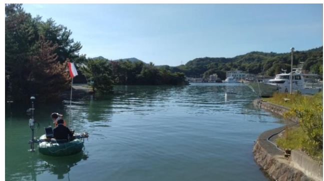
図3 音響測深機を用いた深淺測量
