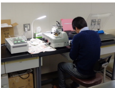
図7 滑走式マイクロトーム による薄切研修
