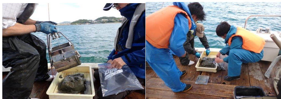
写真 2-8 エクマンバージ採泥器による表層泥の採泥作業の様子
