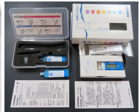
図 3 「堀場アドバンステクノ」製 コンパクト型水質計 LAQUAtwin-pH-11B (校正用標準液による 2 点較正)
