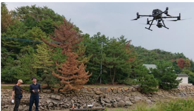
図2 ドローンを用いたレーザ測量
