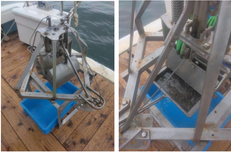
写真 2-9 スミスマッキンタイヤ型採泥器による採泥作業の様子
