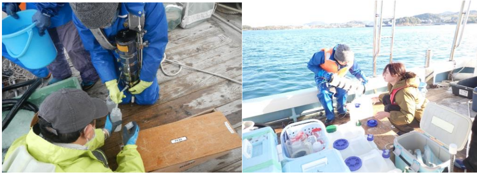
写真 2-4 バンドーン採水器による採水の様子
