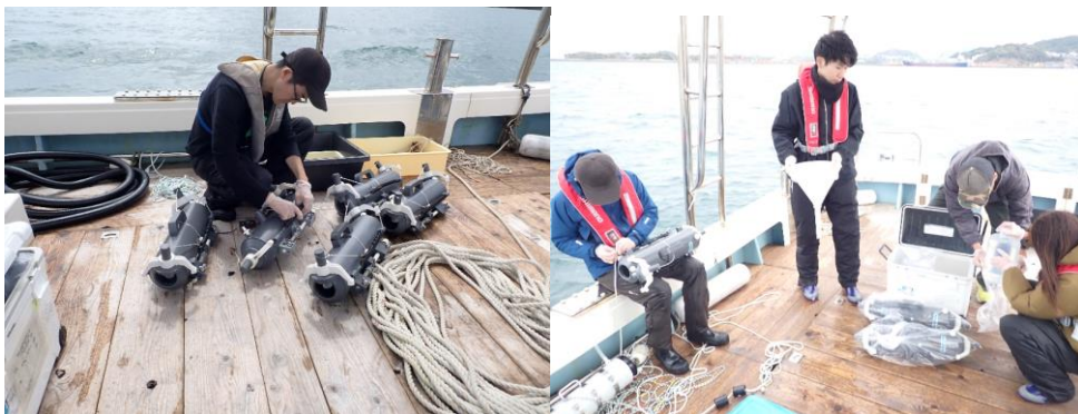
写真 2-5 ニスキン採水器による採水作業の様子
